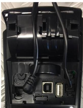
Collegare l'alimentazione ad una presa elettrica e il cavo di rete alla porta 2,3 o 4 del router Fortech.
