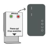
Il Virtual Token è un kit che si installa su piste e accessori, in sostituzione della gettoniera.
