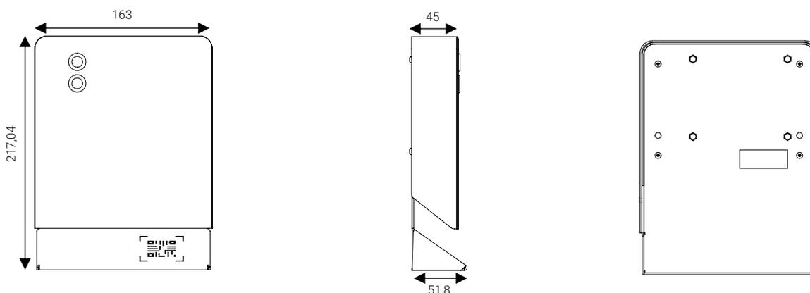
Il dispositivo è costituito da una custodia in lamiera d'acciaio INOX IP67.
