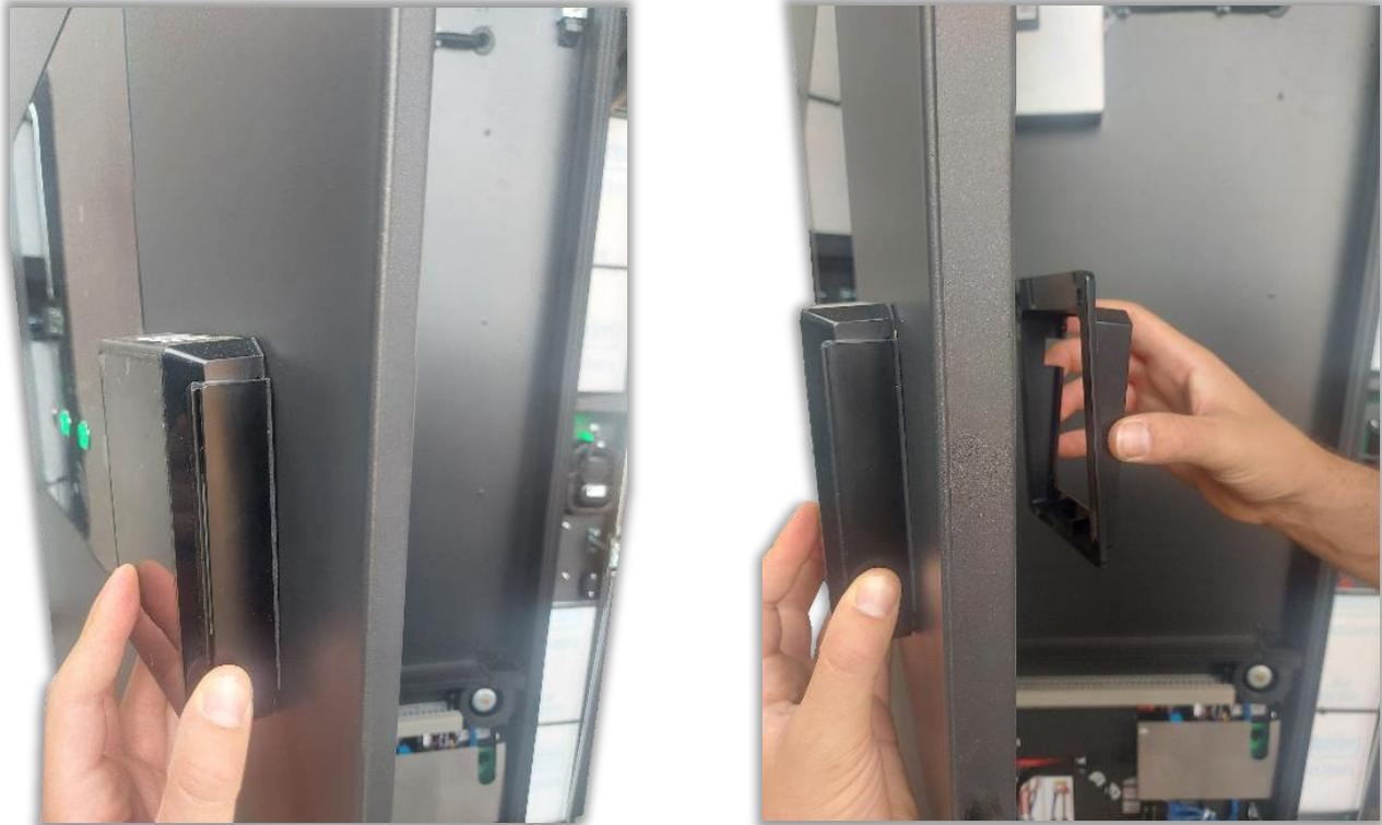
Avvitare e fissare così la staffa di montaggio allo sportello display e al terminale OPTcompact.
